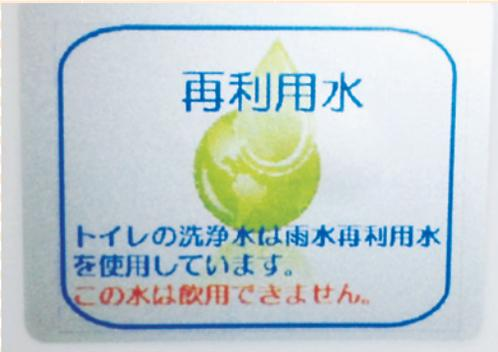
沖縄では昔から雨水を天水として庭の散水等で利用してきましたが、当院でも環境対策として施設内のトイレ(大便器、小便器)に雨水を利用しています。病院建物に落ちた雨は貯留層でろ過した後に洗浄用として使用しています。一番手軽で経費削減にもつながっています。ちなみに飲料水や手洗いは水道水を使用していますので安心してご利用下さい。
