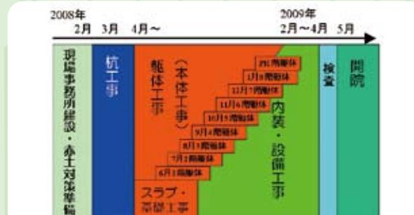
新病院建設の工程は現在、杭工事を行っています。222本の杭を使用し地面にドリルで最大約19メートル掘削し杭を埋め込みます。従来のハンマー式に比べ騒音や振動が非常に少ない方式を採用しています。
